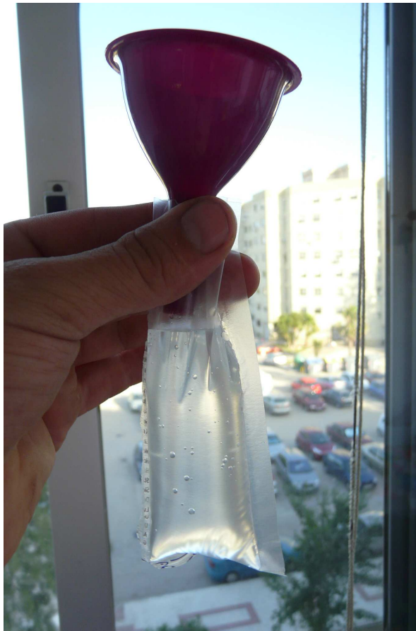
Fig. 8: Llenado de la bolsa para detectar posibles fugas.
